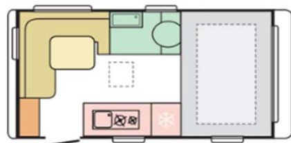
391 PD Posti letto 2 Peso da Kg 1.100 Lungh. int 4.06 m Lungh. Est. 6.10 m Largh. 2.19 m
